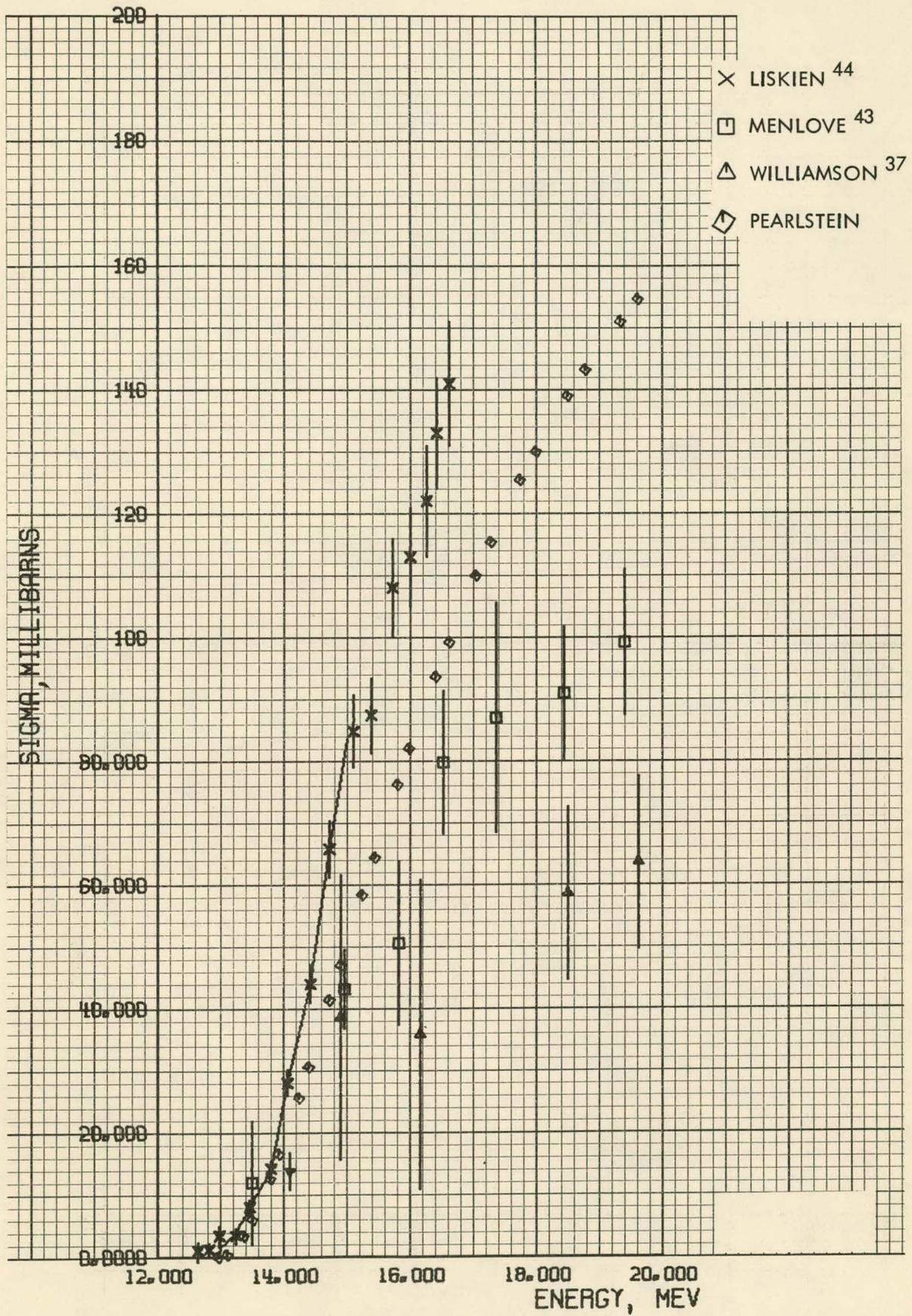
FIG. 17 (n, 2n) CROSS SECTION
